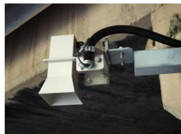
PCを接続して6段階の水位を自由に簡単に設定できます。使用する河川のさまざまな水位にきめ細やかに対応します。検出距離は5mと10mのタイプがあります。(\*2) 小型で軽量ですので取り付けもコンパクトで容易です。
