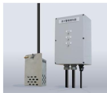
センサーはすでに冠水警報用として実績のある自社の冠水警報用センサーのケースを小型化して使用し、冠水警報ユニットと同様に水垢や錆で検出感度が低下する従来の電極式水位計の欠点を解消しています。
